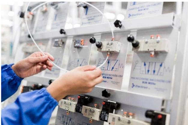
Une unité didactique d'Hydraulique est conçue pour étudier et expérimenter les circuits de puissance et de contrôle oléodynamique, avec des panneaux comprenant un certain nombre de composants commodément installés et exposés pour la formation et l'expérimentation.
