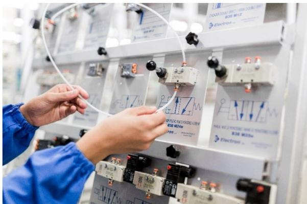
Los componentes se montan en módulos que se pueden instalar en un marco de panel o en un banco para la demostración del maestro y el uso del estudiante.
