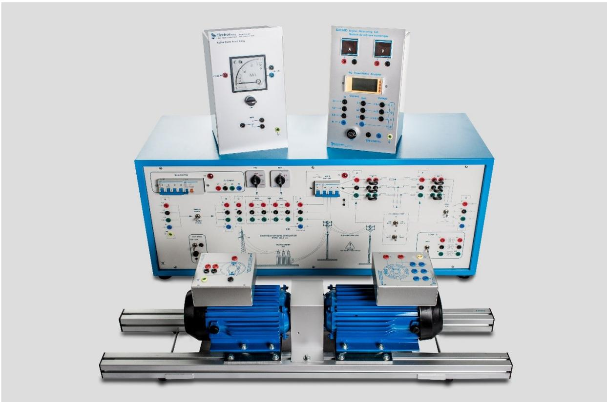
Este laboratorio simula un sistema de generación, transmisión y utilización de la vida real basado en máquinas eléctricas estándar, instrumentos y una línea de transmisión simulada.
